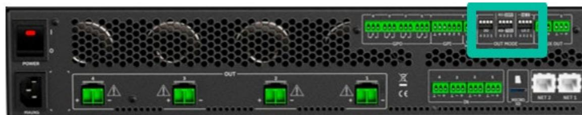
Sélectionnez le mode de fonctionnement approprié pour ne pas endommager les enceintes. **Ne connectez jamais de charges inférieures à 2 ohms lorsque vous travaillez en mode basse impédance.**
